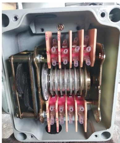
Рис. 10 – Командоаппарат (внешний вид со снятой крышкой)
