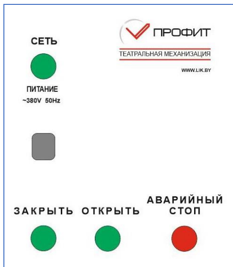
Рисунок 8.2 – Функциональная панель шкафа управления
