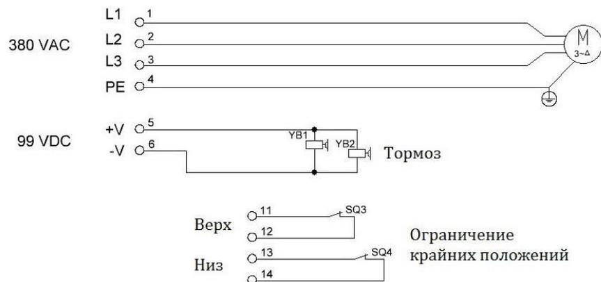
Рисунок 4.1 – Электрическая схема управления работой лебедки
