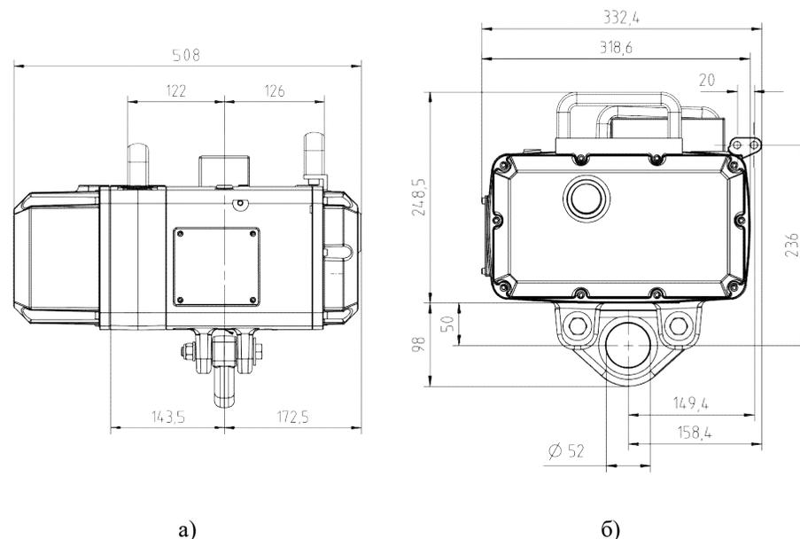
Рисунок 3.2 – Габаритные размеры лебедки
